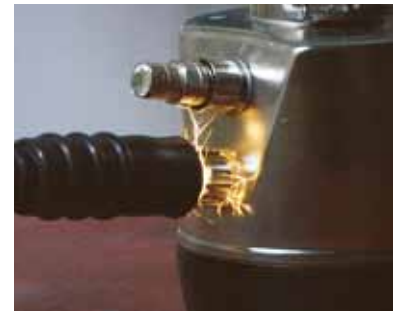
Célula de carga POWERCELL PDX comprobada en laboratorio con una simulación de rayo.
