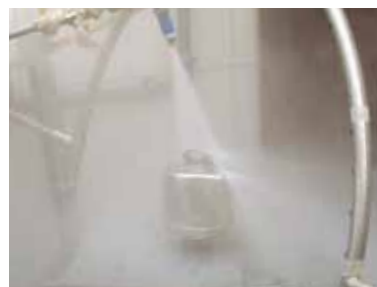
Las células de carga POWERCELL PDX han superado pruebas rigurosas de resistencia al agua a alta presión y a la inmersión en líquidos.
