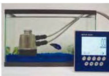
Las conexiones de cable forman un sello hermético incluso bajo el agua.
